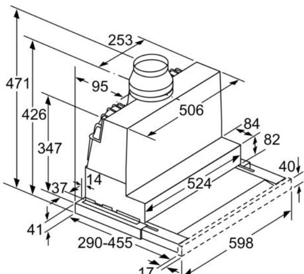
Tiefenanpassung des Filterauszuges bis 29 mm möglich
